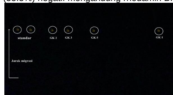
Gambar 1. Hasil Pengujian KLT Rhodamin B pada Sampel Gula Kapas Arum Manis di Bawah Lampu UV
